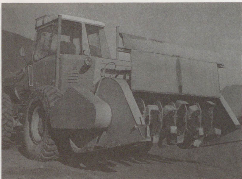
Bild 4.33–4.34 Der Rotor einer Hochleistungsbodenfräse neuzeitlicher Konstruktion. Die wesentlichsten Konstruktionsmerkmale des Rotors: auf kräftige, robuste Scheiben montierte, ganz kurze Messer. Die Scheiben sind auf der Welle versetzbar. Der Rotor dreht sich entgegengesetzt zur Fahrtrichtung (Respecta)
