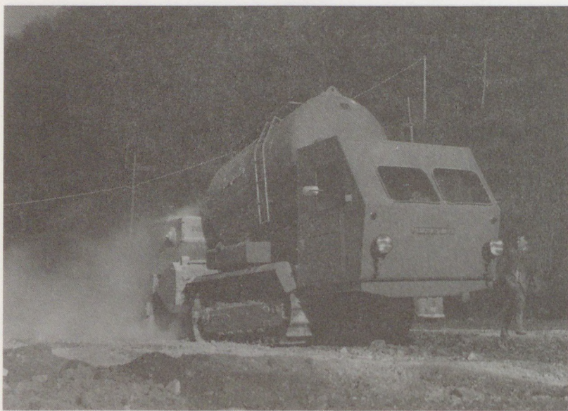
Bild 4.30 Das erste von der Baumaschinenindustrie hergestellte Verteilergerät auf Raupen, welches serienmäßig gefertigt wurde. Aufsatzsilo und Ladekasten weisen 6,5 \text{ m}^3 Inhalt auf. Die Streuleistung beträgt 1 \text{ t/min}
