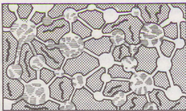
Bild 5.24 Schematische Darstellung des Hohlraumes bei einer Stabilisierung (nach Fetz 1978)
