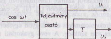
1.1. ábra. Azonnali frekvenciamérő vevő elve
