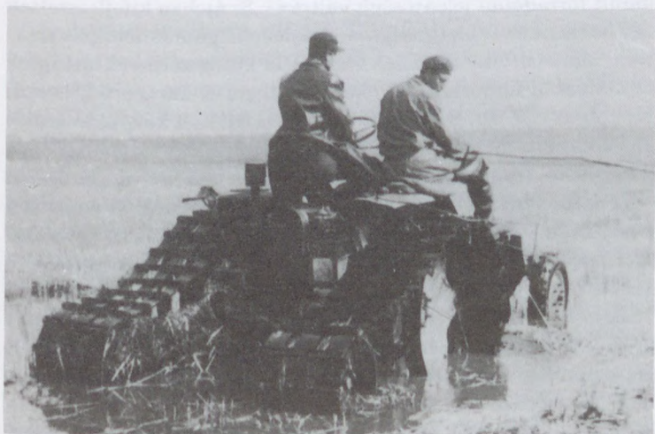
7. ábra. Zanati-féle féllánc talpas mocsárjáró nádarató (MGI, 1961)
