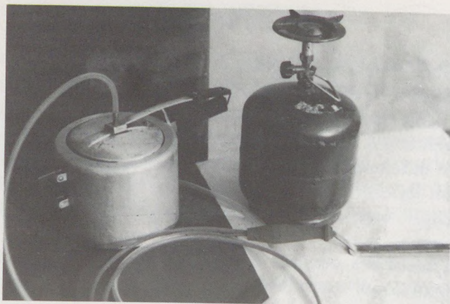
25/b. Hőforrás a gőzös fedelezőhöz és kukta főzőfazékból alakított gőztermelő készülék (fotó: Barta Vince)
