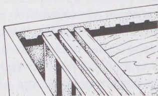
8/a. Fogazott keretsín váll nélküli keretekhez. A gépi fedelezésnél nagy előny a váll nélküli keret!
