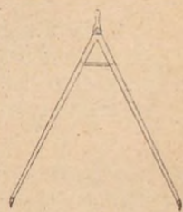
11. ábra. A hossz mérő fakörző
