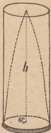
74. ábra. A tőalakszám kiszámításához szolgáló henger alapsíkja összeesik a kúp alapsíkjával (a fa vágáslapjával)
