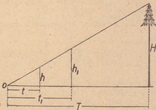
66. ábra. A magassági mérce leolvasása arányos a távolsági mérce leolvasásával
