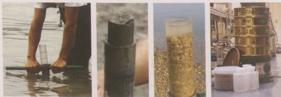
38. ábra. 1.: Kézi csőmintavevő, 2-3.: iszapos-agyagos és kavicsos mederanyag minták, 4.: rázószita nedves szitáláshoz
