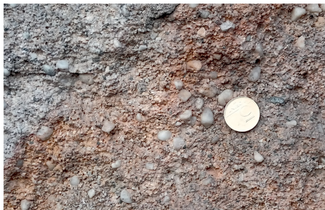
Közepesen osztályozott, kovás cementű, limonitos festésű, kavicsos durvahomokkő, lábazati építőkő (SzO)
