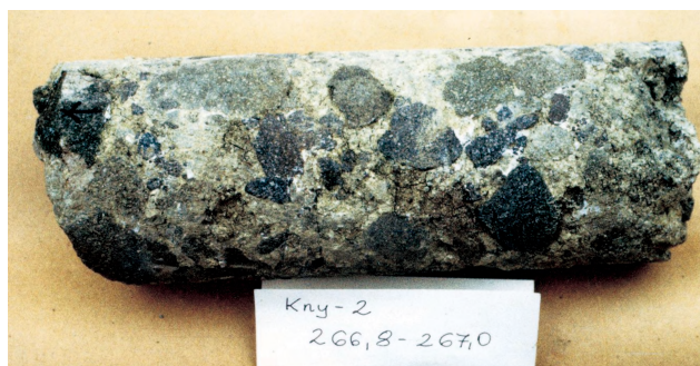
Agyagásványosodott andezit-agglomerátum (Kápolnásnyéki Andezit), Velencei-hegység, Kápolnásnyék Kny-2 fúrás (DTM)
