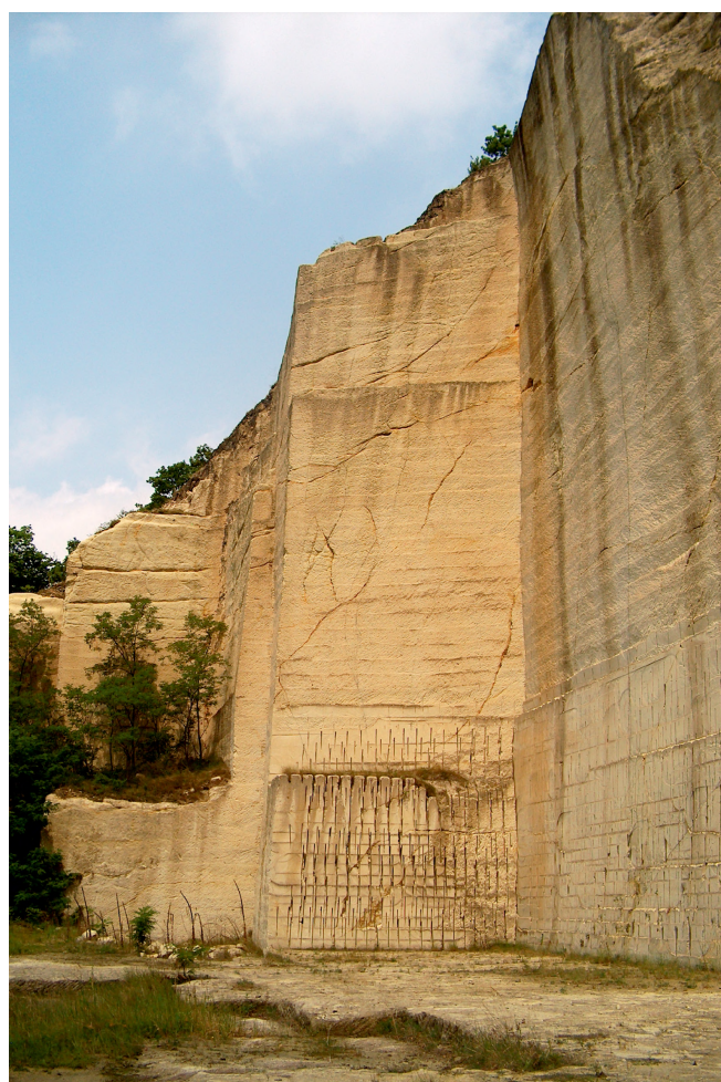
A tari Fehér-kőbánya felül véséssel, alul pedig fűrészeléssel kialakított függőleges fala (PrP)
