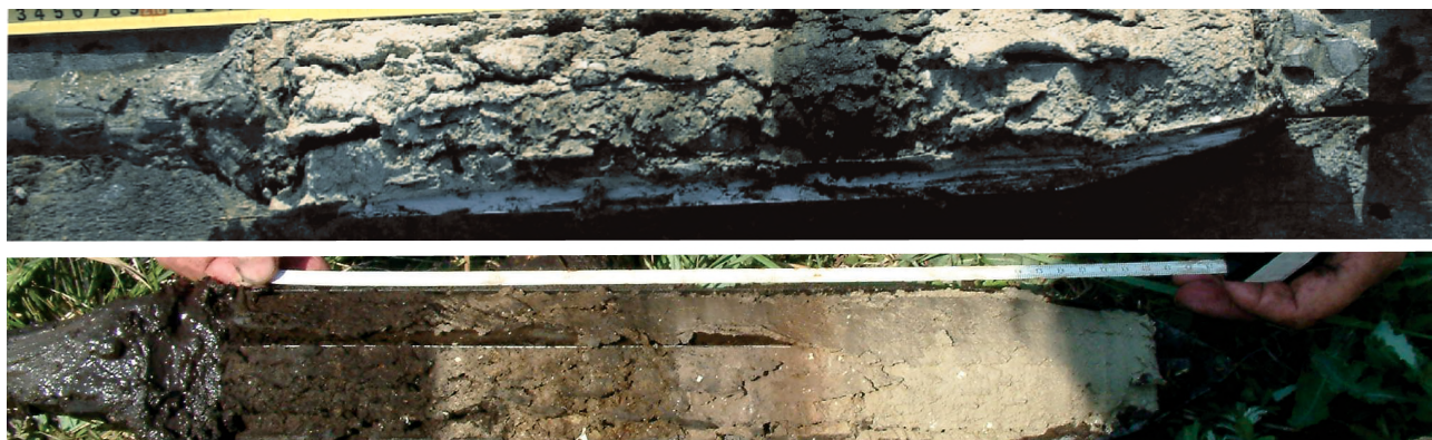
Fent: Kora holocén mészszip szintjében feltárt kékesszürke agyagréteg, Fenékpusztá, fűrőmag (SP). Lent: Tavi mészszip és tőzeg rétegeinek váltakozása egy balatonedericsi fúrásban (SP)
