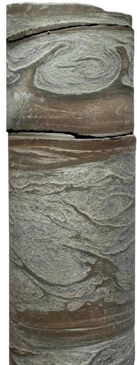
Gyors ülepedést jelző, terheléses labda- és lányszerkezetek homokkő- és aleurolitrétegek között, Iharosberény Ih-I fúrás, 1241 m (KL)
