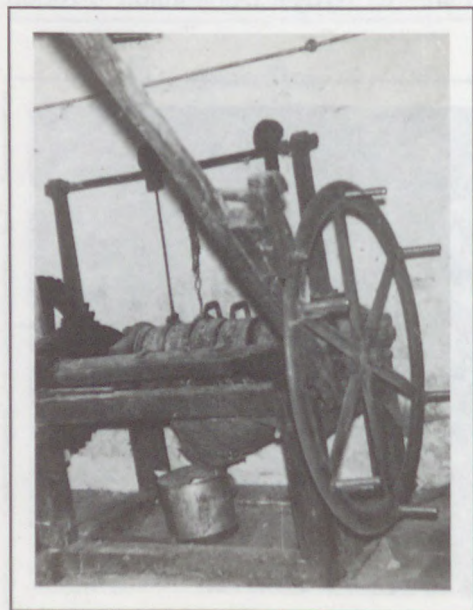
65. kép. Háziiparilag készített fekvőhengeres csigasajtó az 1930-as évekből. Bize, Somogy megye. A szerző felvétele 1976.
