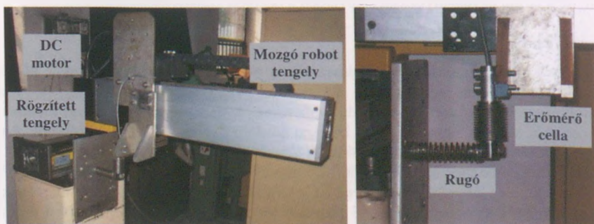
47. ábra. A digitális erőszabályozású kísérleti robot (bal oldal); a robot és a környezet kapcsolata (jobb oldal)
