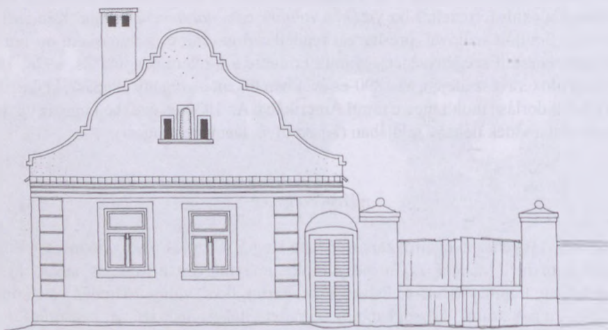
35. ábra. Barokkos oromfal és vakolatdíszes homlokzat. Csepreg (Sopron vm.)
