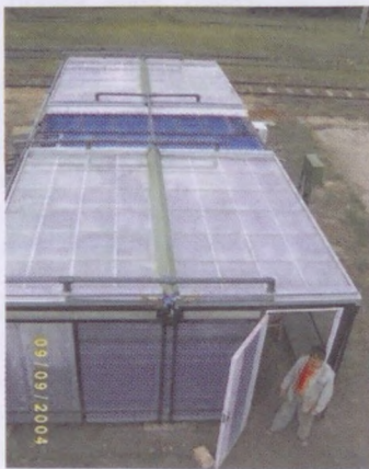
50. ábra: Napenergiát hasznosító víztisztító Hidas külterületén.
