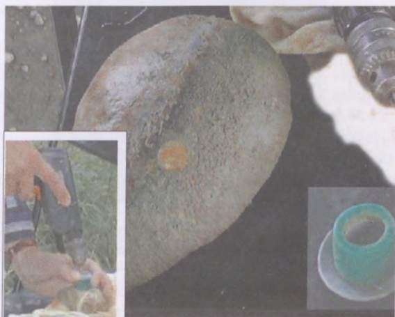
7. ábra: A mintavevő eszköz képe és egy algabevonatos kő, melynek egy részéről (kör alakú terület) eltávolították a bevonatot.
