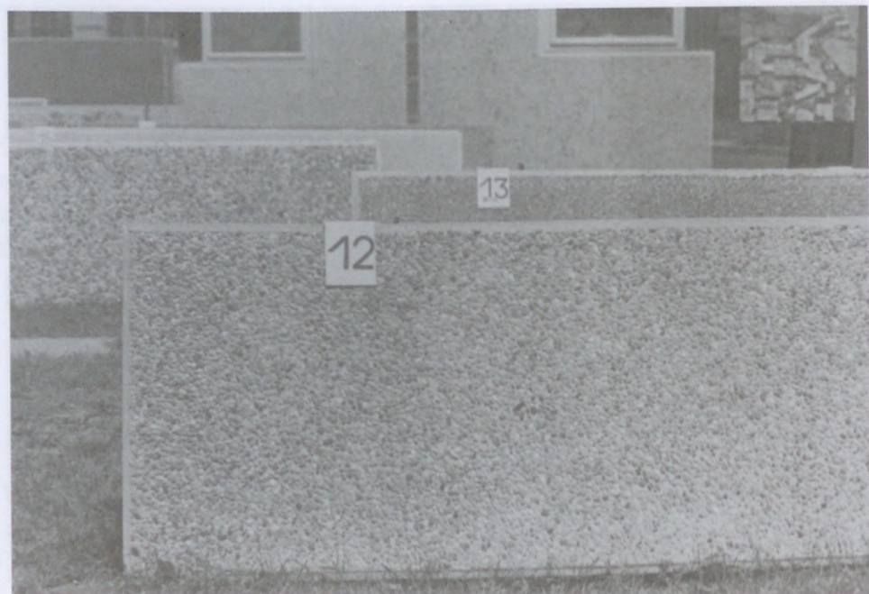
8.4. fénykép. Mosott felület, 7–10 mm átmérőjű dunai kavicszemcsék, normál portlandcement habarcsba szórt szemek [Kiállítás (1969)].
