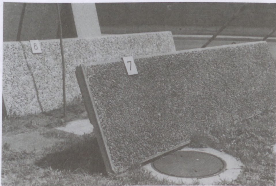
8.2. fénykép. Mosott felület, kantavári fekete mészkőzúzalék, 3% fekete oxidfestékkel és normál portlandcementtel készített habarcsba szórt adalékszemek [Kiállítás (1969)].
