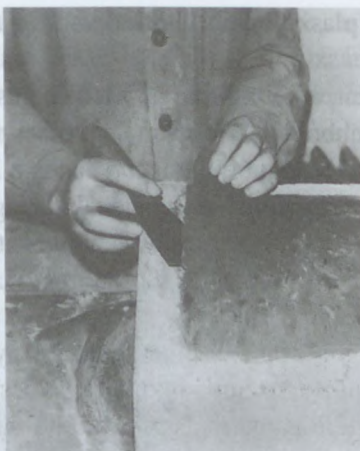
3.22. ábra. A plasztílinréteg lefejtése
