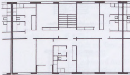
14.10. ábra. A győri és a miskolci házgyár elemeivel tervezett 4 emeletes lakóházak homlokzatsémája (a ábra) és típuszekciói (b és c ábra) [Csordás T. (1969)]
