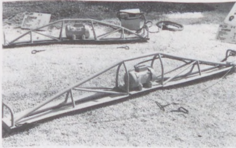
5.26. ábra. Hazai vibrátorok. a) Külső meghajtású rúdvibrátor; b) FM típusú, belsőmotoros rúdvibrátor; c) pallóvibrátor (Varga János FÉNYSZÓV)
