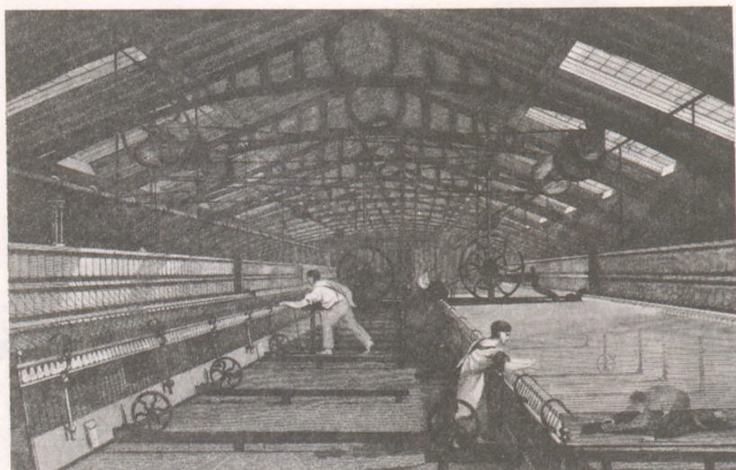
Gyáripar: fonás a szakaszos működésű fonógép segítségével 1835-ben. Amíg a nő az előző képen meghatározhatta saját tempóját, annak, aki a gyárban dolgozik, lépést kell tartania a géppel. A kép jobb alsó sarkában: a szálakat a gép alatt összesöprő fiú állandó balesetveszélynek volt kitéve
