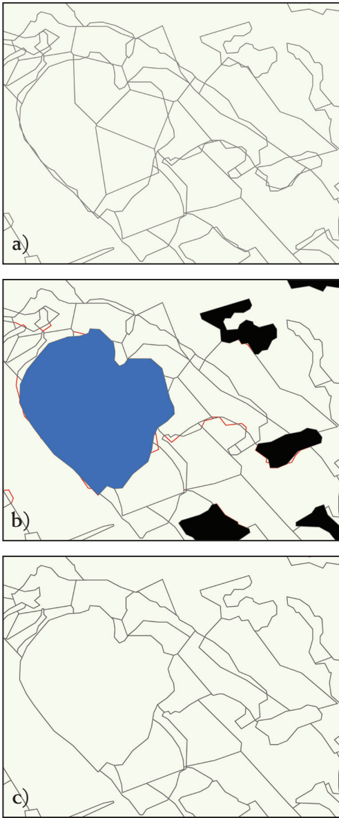
12. ábra. Topológiai és tematikai javítások az egyesített térképen: a) az egyesített térkép részlete a töredékpolygonokkal, b) töredékpolygonok eltávolítása (piros vonal), felülírás a CORINE térkép vízfelületeivel (kék), felülírás a D-TMap térkép egyélőhelyes polygonjaival (fekete), c) az egyesített térkép egy részlete
