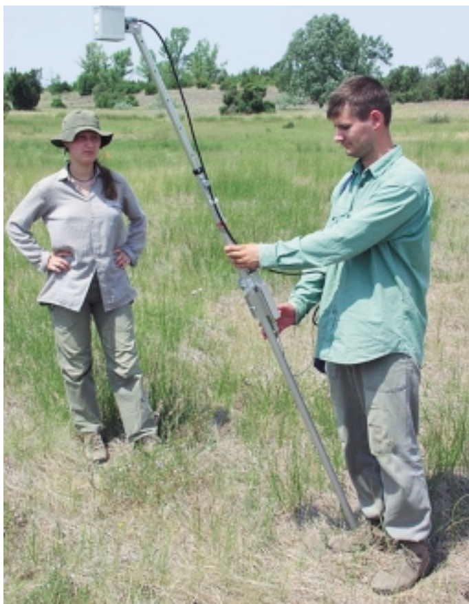
2. ábra. A CROPSCAN terepi sugárzásmérő használata egy felhagyott homoki szántón Orgovány térségében
