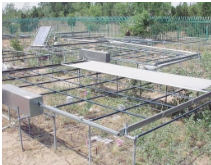
1. ábra. Klímaszimulációs kísérleti berendezés a Kiskunságban, Fülöpházán
