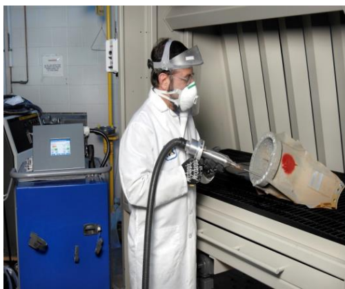
13. ábra Helikopter rotor alkatrész felújítása hidegszórással kézi módszerrel [11]
