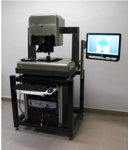
AltiSurf®520 típusú 3D-s felületi érdességmérő berendezés
