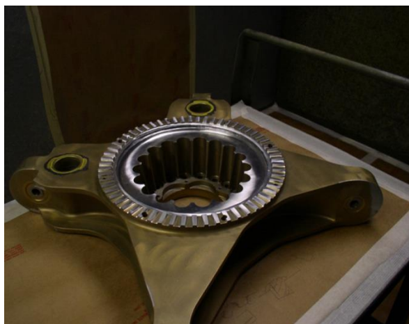
15. ábra Helikopter Al-Mg alapú ötvözetből készült alkatrésze felújítás előtt [12]
