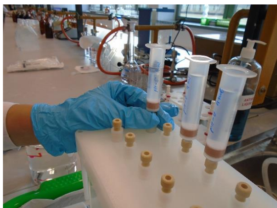
9. ábra: Minták leoldása az SPE oszlopról
