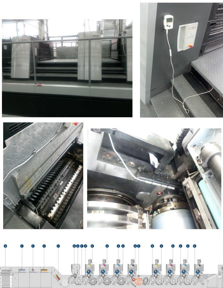
1. ábra: A mérőműszer elhelyezése, rögzítése a nyomógép piros hengerrel jelölt fordítójánál, gépfelépítés [15]
