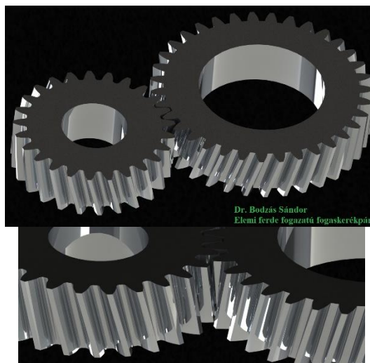
4. ábra. Konkrét geometriájú elemi ferde fogazatú fogaskerékpár tervezése és modellezése
