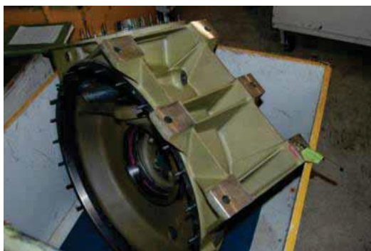
14. ábra Különböző helikopter hideg szórással felújított alkatrészek
