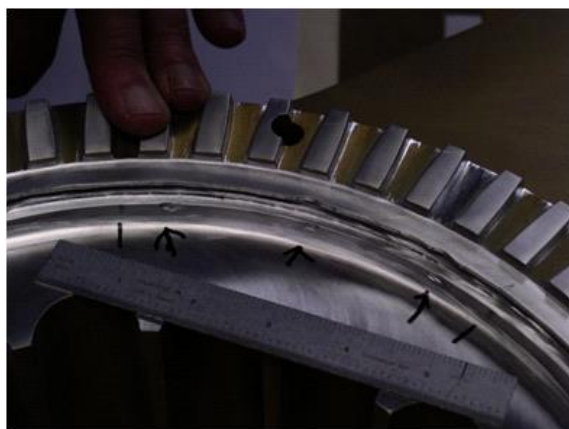
a/ Megrongálódott kopott felület részek (korróziós kimaródások) a gyűrű alsó részén
