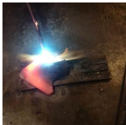
2. ábra: Az ötvözetpor rétegfelvittele meleg fémporaszórással
