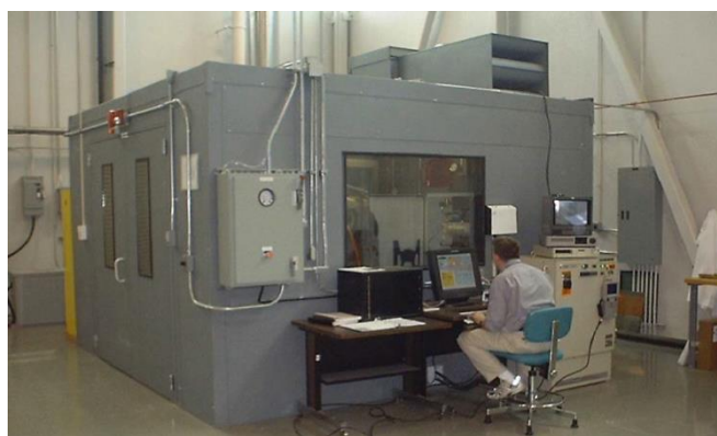
12. ábra Hidegszóráshoz használt zárt kabin és a külső vezérlés [6]
