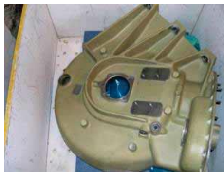
14. ábra Különböző helikopter hideg szórással felújított alkatrészek
