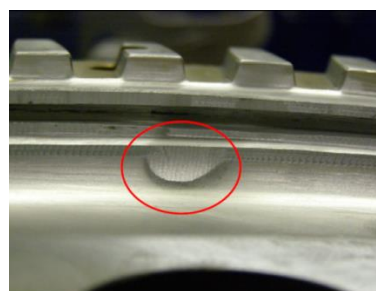
b/ A hidegszórással feltöltött hibahely megmunkálás után
