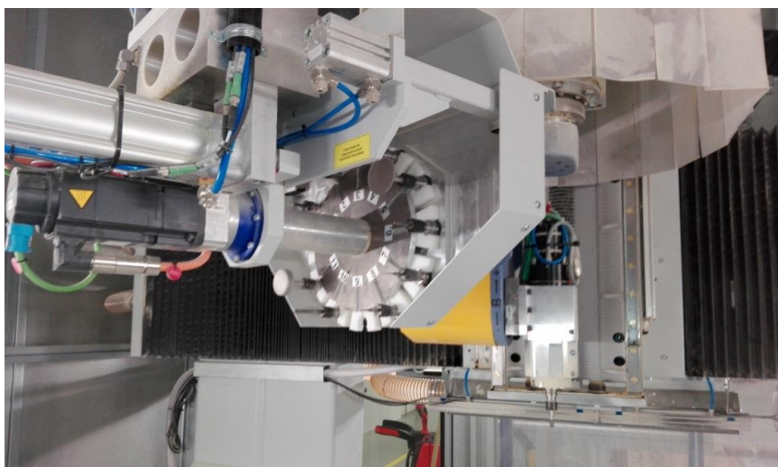
4. ábra. A főorsó és a 12 férőhelyes szerszámtár
