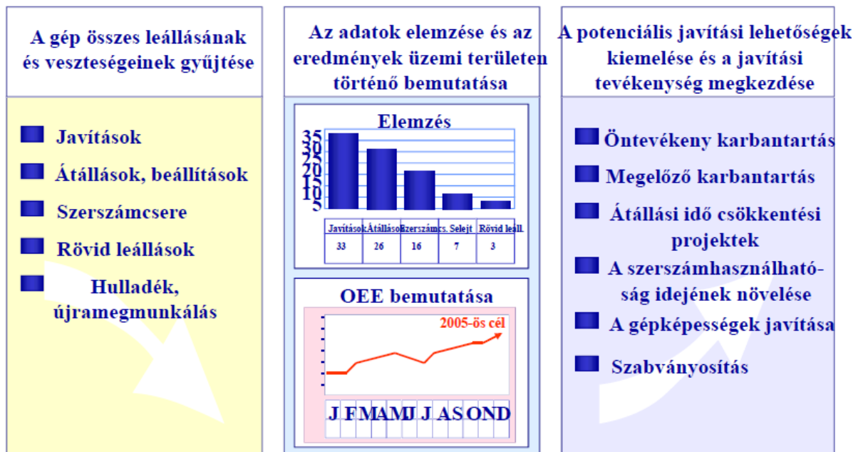
6. ábra. Az adatgyűjtés fontossága az OEE mutató meghatározásához [4]
