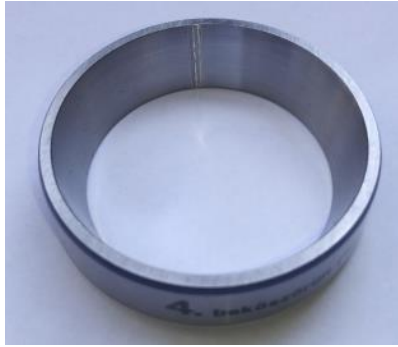
7. ábra. A mérés során alkalmazott 30205 típusú kúpörgős csapágy külső gyűrű a gördülópályán köszörülési hibával (631 \mu\text{m} szélesség)
