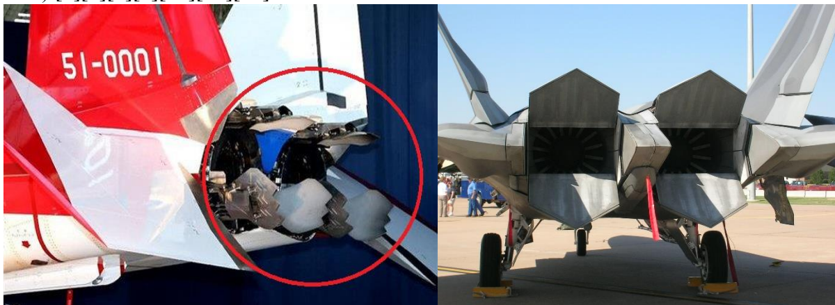
4. ábra. A Mitsubishi ATD-X 12 (bal) és az F-22 Raptor 13 (jobb) tolóerő vektor szabályzó rendszerei
