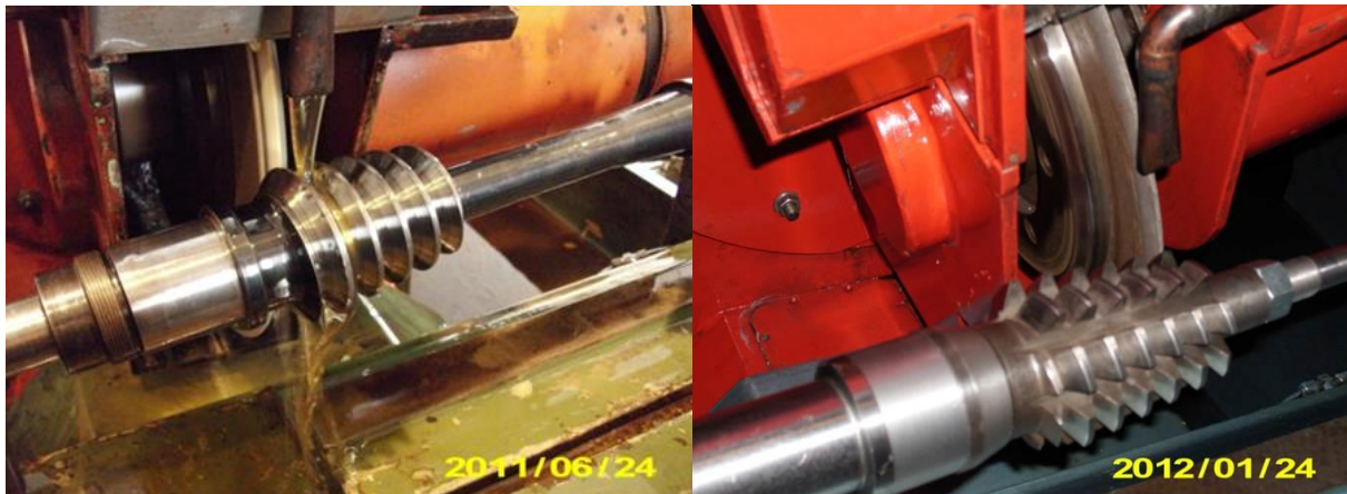
7. ábra. A képen a csigatengely köszörülése (a) és a maró hátraköszörülése (b) látható (DifiCAD Mérnökiroda Kft.)
