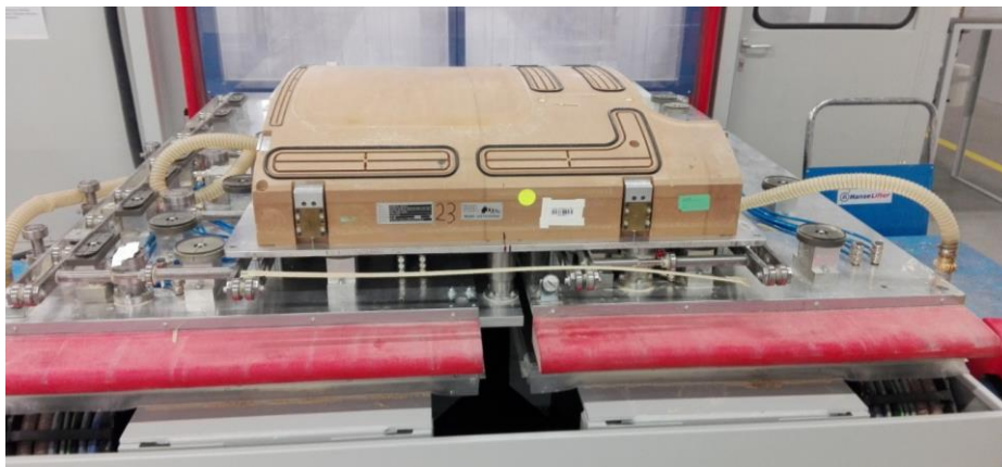
3. ábra. Szerszám rögzítése a gép két munkaasztalán
