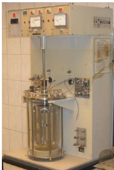
6. ábra: A biogáz vizsgálathoz alkalmazott dinamikus berendezés (Dr. Bokányi L. és Varga T., 2011)
