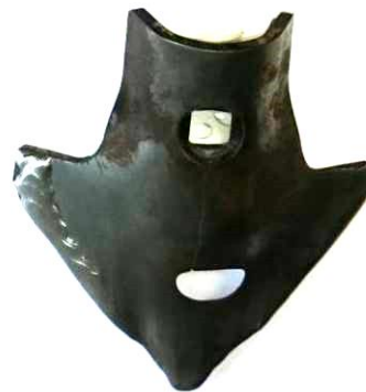
1. ábra: Kopott mezőgazdasági gépalkatrészek
