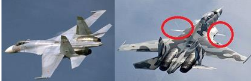
3. ábra. A Su-27 Flanker 7 (bal) és a Su-35 Flanker-E 8 (jobb) közötti sárkányszerkezeti különbség [17][18]
