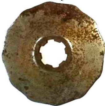
Kukoricakombájn csőtörő adapterének szárzúzó kése és tárcsája
