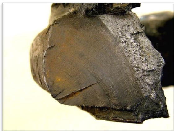
10. kép. A törött profil baloldali ága
