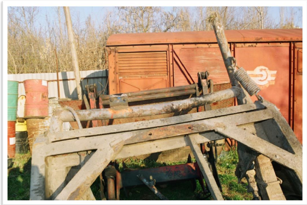
1. kép. A pótkocsi összetört első futóműve
