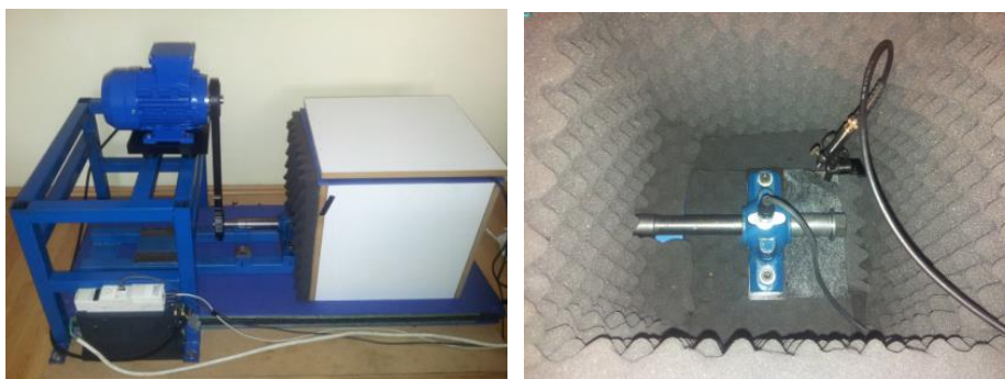
6. ábra. Csapágyvizsgáló tesztpad rezgés- és akusztikai mérésekhez
