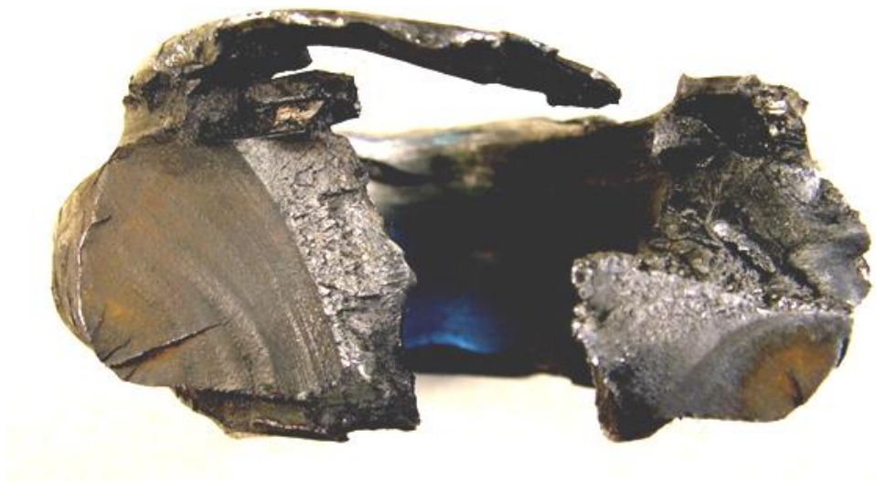
9. kép. A darab törött keresztmetszete
