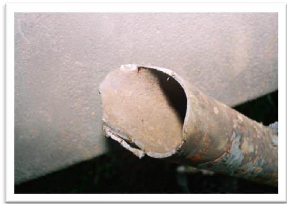
4. kép. A cső felső részének törésképe
