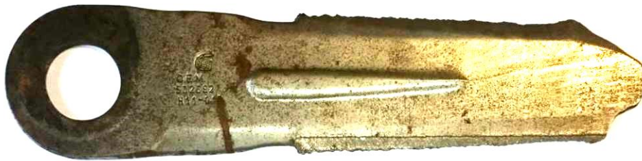
Kukoricakombájn csőtörő adapterének szárzúzó kése és tárcsája
