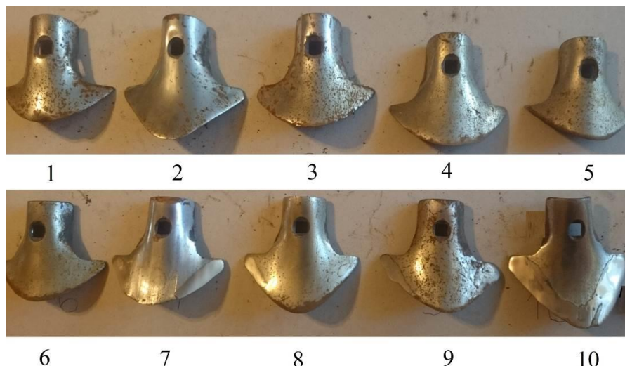
9. ábra. A kísérleti darabok használat után, hőkezelték (felső sor) és felszörtak (alsó sor)
