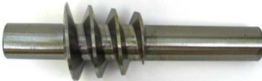
1. ábra Elvi pontossággal köszörült Archimédeszi kúpos csiga
