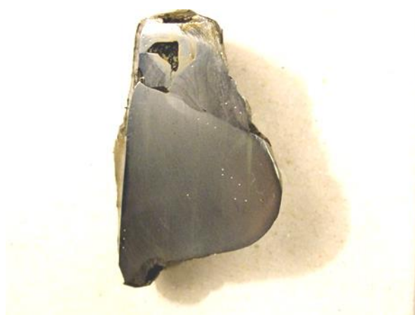
12. kép. A hegesztéssel javított profil keresztmetszete csiszolva
