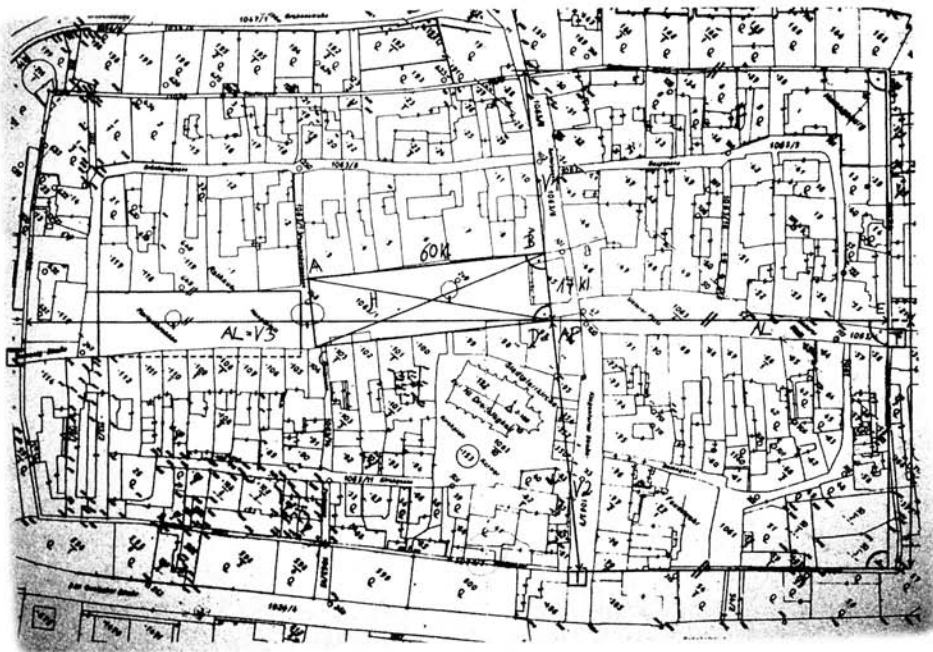
Abb. 4. Die Rekonstruktion der Absteckung der gotischen Neuanalge von St. Veit.
