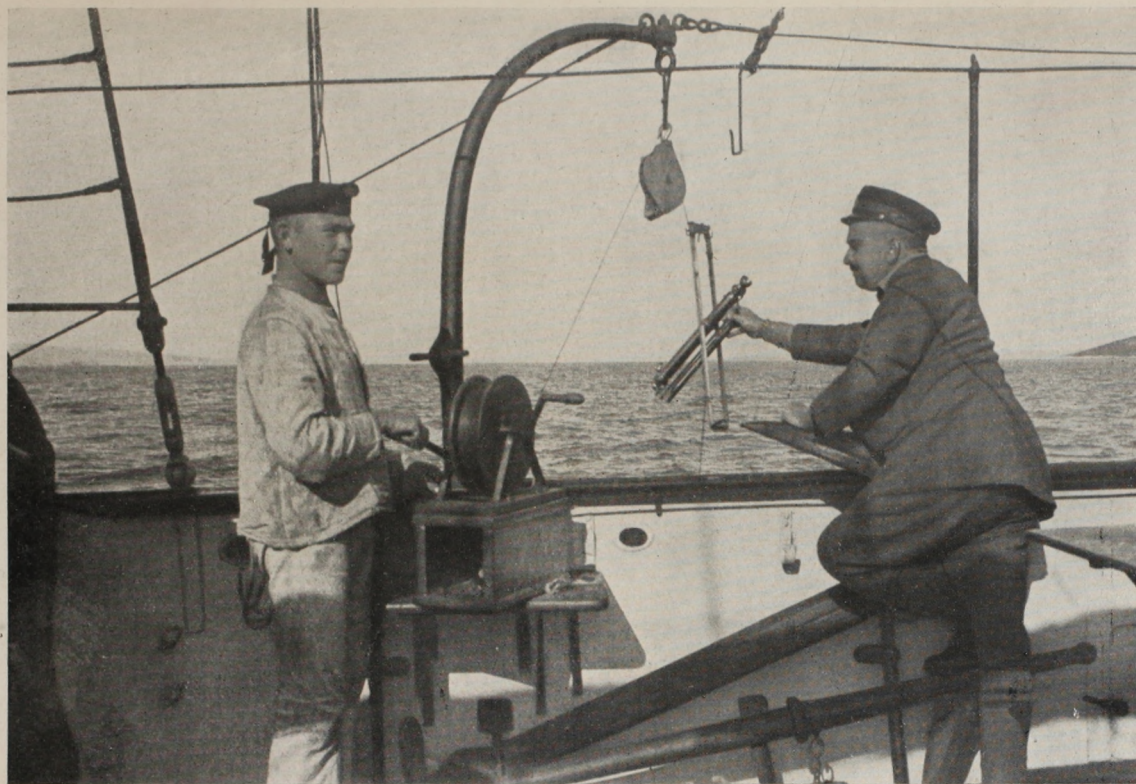
A tengervíz sótartalmának meghatározására Richard-palackkal vízmintát merítenek a «Najade»-ről.
