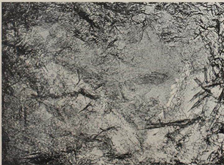
19. kép. Mesterséges tengervíz első felszíni fagyása. A term. nagyságnak mintegy fele. (Szerző fényképe.)
