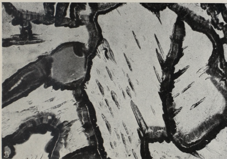
14. kép. A tengeri jég szerkezete. Dió- és tojásmag nagyságú darabok összefagyásával keletkezik, az egyes darabok közt könnyen olvadó, sós részletek vannak. A Tyndall-virágok síkjának iránya minden darabban más.
