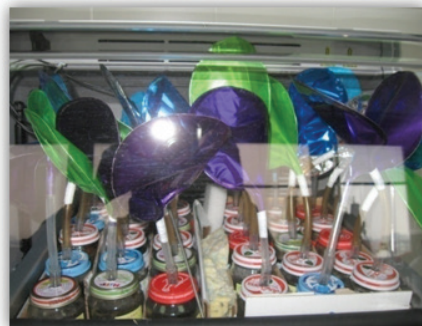
1. ábra: A szedimentben található szerves anyagok anaerób degradálására szolgáló reaktorok
