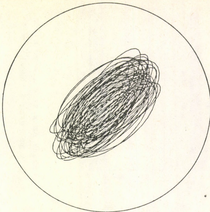
22f ábra: A rudmozgás pályája (kvázi-monokromatikus gerjesztés)
