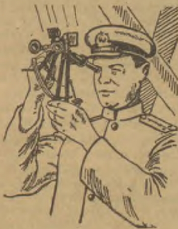
8. ábra. Megfigyelés a szekstánssal. A szekstánst ma is használják a hajósok.
