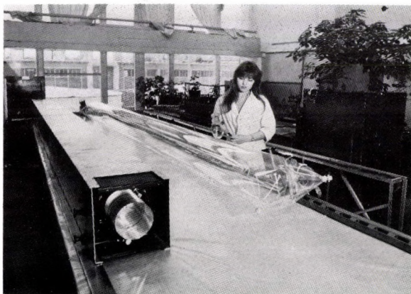
2. A folyadékszintillátor belső falára felviendő műanyagfólia előkészítése és egy összeszerelt hasáb.
