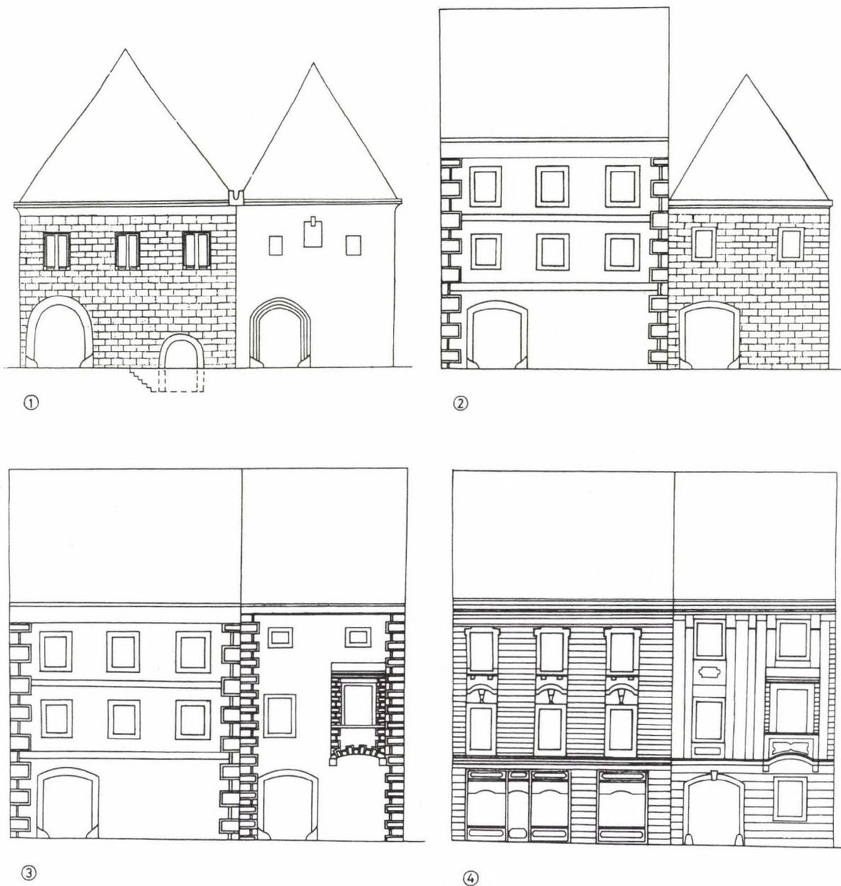
Abb. 1: Entwicklungsphasen des Hauses Michalská-Strasse 14-16 in Bratislava. Theoretische Rekonstruktion der Fassaden. 1: Dritte Entwicklungsphase. 1. Hälfte des 15. Jh.; 2: Fünfte Entwicklungsphase. Um 1495-1532.; 3: Siebente Entwicklungsphase. 1. Drittel des 17. Jh.; 4: Neunte Entwicklungsphase. Um 1760 und 1. Drittel 19. Jh.
