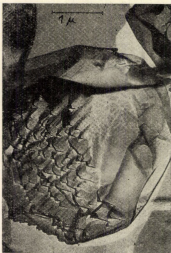
13. ábra. Koncentrált oldatból leválasztott bárium-szulfát-csapadék, izzítás után kioldva (replika)
