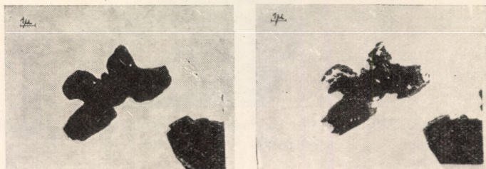
10. ábra. Winkler-féle módszerrel leválasztott csapadék a) kioldás előtt, b) kioldás után
