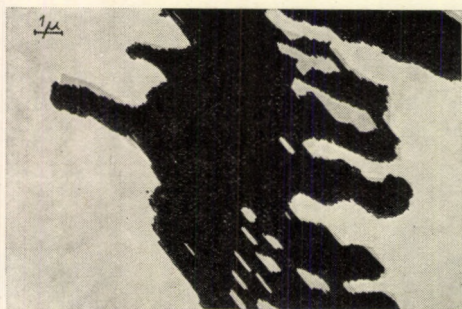
12. ábra. Winkler-féle módszerrel leválasztott és izzított csapadék, kioldás után
