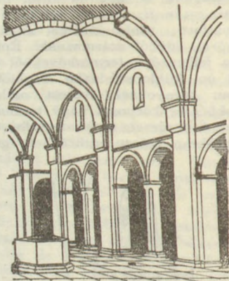
Boltszakaszos templombelső haránthevederekket
