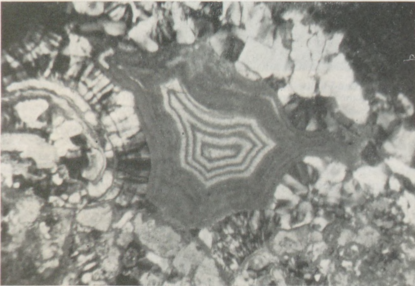
106. ábra. Mandulaüreg-kitöltés. Achátszerűen sávos kalcit, szemcsés kvarc, kalcidon. Gyöngyösoroszi, altáró, 170 m. Vékonymetszet. Nagyítás: 35 ×. + Nikol. (Koch—Mezősi nyomán)
