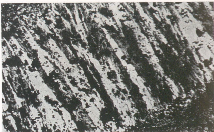
152. ábra. Durvarostos piro-luzit-ér kriptomelánban (manganit utáni pszeu- morfoza), Úrkút, lejtősakna. Érecsiszolat. Nagyítás: 100 ×. + Nikol. (GRASSELY Gy. nyomán)
