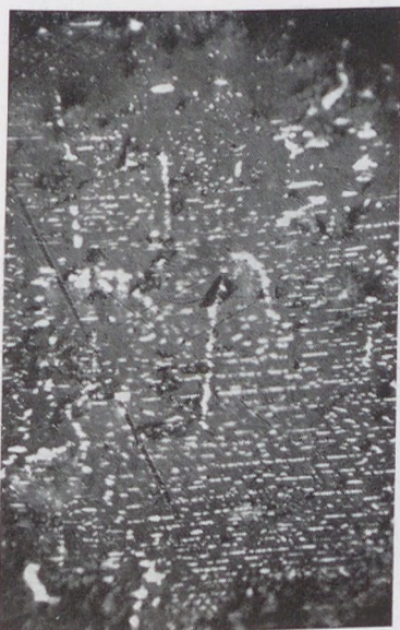
88. ábra. Wurtzit. A 0001 lapokkal párhuzamosan betelepült kalkopirit-zárványsorok. Gyöngyösoroszi, Károly-telér. Érc-esziszolat, olajimmerzió. Nagyítás: 400 ×. (KOCH—GRASSELY nyomán)
