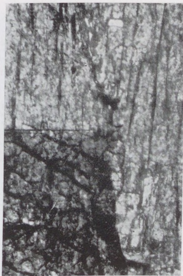
89. ábra. Wurtzit és szfalerit egymás mellett. A két ZnS-módosulat éles határral különül el egymástól. (A wurtzit a világos színű). Gyöngyösoroszi, Károly-telér. Vékonyesziszolat. Nagyítás: 160 ×. || Nikol
