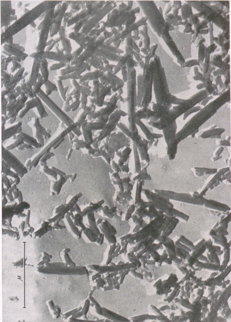
101. ábra. Gyöngyösroszsi halloysit elektronmikroszkópos képe. Nagyítás: 30 000 ×. (G. Sz. GRICSAENKO felvétele a Moszkvai Tud. Akadémia Elektronmikroszkóp Laboratóriumában)
