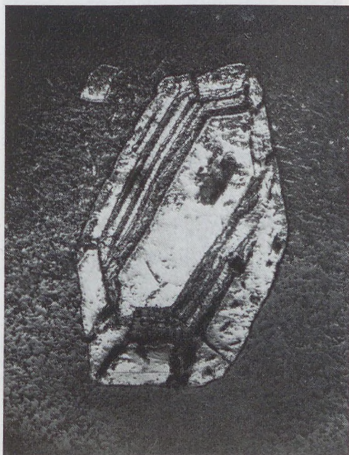
5. ábra. Részleges felemésztés következtében zónássá vált antimonitkristály c tengelyre merőleges metszete. Velencei hegység, Meleg-hegy. Ércsiszolat. Nagyítás: 65×. (KUBOVICS I. felvétele)
