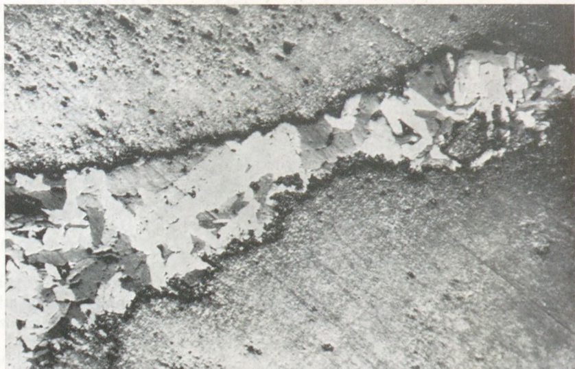
156. ábra. Durvakristályos manganit-üregkitöltés kriptomelánban. A manganitfészket tūvasérc-zsinór határolja. Úrkút, lejtőszakna. Érecsiszolat. Nagyítás: 200\times . + Nikol. (GRASSELY GY. nyomán)
