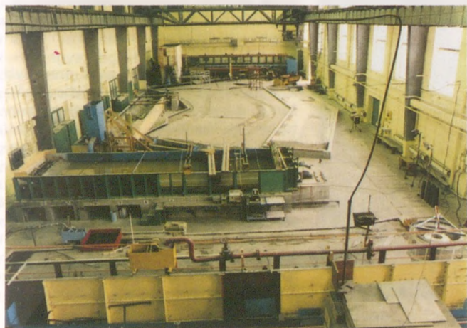
Hidraulikai laboratórium a jelenségek vizsgálatához szükséges üvegcsatornákkal és medermintával
