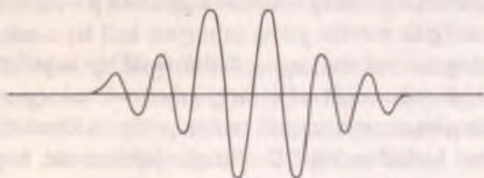
10-1. ábra Ilyen hullámcsoport úgy jön létre, hogy különböző hullámhosszúságú síkhullámok adódnak össze.
