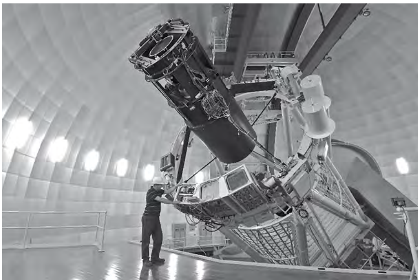
4. ábra. Az Angol–Ausztrál Observatórium 3,9 méteres távcsöve, valamint az üzemben lévő 2dF szállpozicionáló rendszere a Siding Spring Observatóriumban (SSO). (Forrás: www.galah-survey.org/details/facilities/ )
