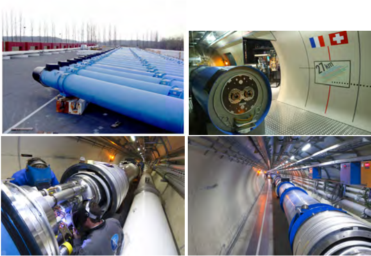
9. ábra. Az LHC részecskegyorsító 100 méterrel a föld alatt, 27 km hosszú körgyűrűben, 9300 mágnes segítségével tartja körpályán, fókuszálja és ütközteti az egymással szemben keringő protoncsomagokat. Balra fent: levitelre és beszerelésre vár az 1232 (15 m hosszú, 35 tonnás) elhajlítómágnes egy része. Jobbra fent: a protonokat két irányban körpályára kényszerítő dipólusmágnesek keresztmetszete (a CERN Microcosm kiállításáról). Baloldalt alul: szerelik az LHC mágneseit. Jobbra lent: a kész LHC-gyűrű.
