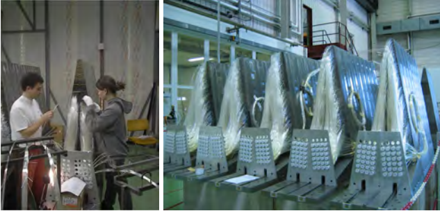
18. ábra. A CMS előreszórt részecskék észlelésére szolgáló dektora. Baloldalt két budapesti diák a kvarcszálakat fűzi be az acéltömbbe fúrt lyukakba, jobboldalt kész elemek várnak ellenőrzésre és tokozásra.
