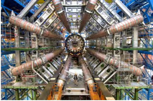
20. ábra. Az ATLAS detektor toroidmágnese, még üresen, az észlelőrendszer beszerelése előtt
