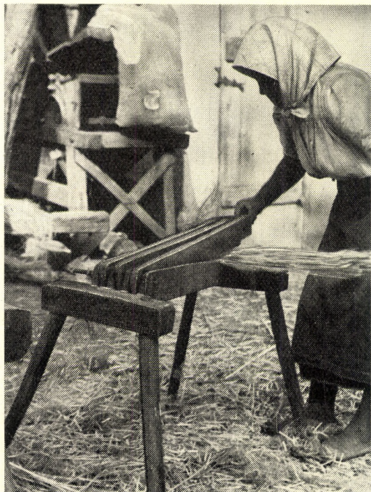
25. ábra. Deszkás szerkesztésű, hármas vágóélű tiló. Kocs, Komárom m.
