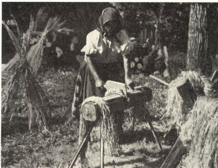
48. ábra. Keresztvályús törőszék. Diósjenő, Nógrád m.
