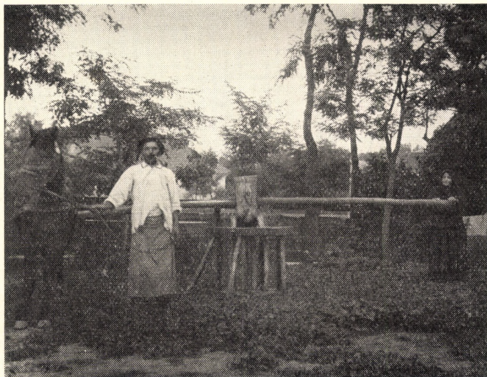
84. ábra. Lóval forgatott kalodás dörzsölő. Fehérgyarmat, Szabolcs-Szatmár m.
