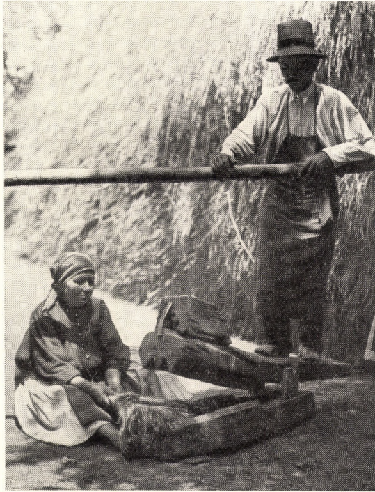
64. ábra. Kölyűs kendertörő — déli típus. Szeremle, Bács-Kiskun m.
