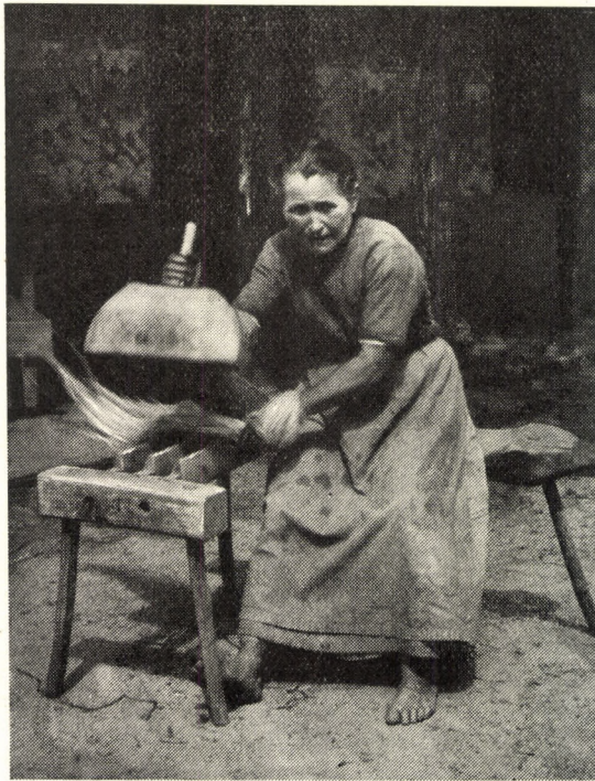
26. ábra. Hármás vágóélű tiló. Nagyjécsa, RNK.
