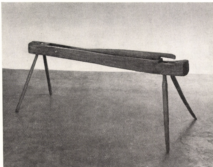
10. ábra. Áttört törzsű, egy vágóélű tiló. Gégény, Szabolcs-Szatmár m.
