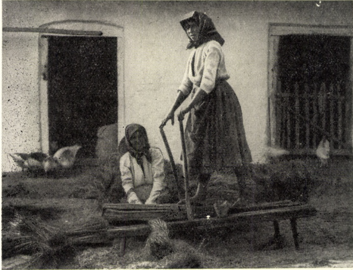
62. ábra. Kölyűs kendertörő — északi típus. Dédes, Borsod-Abaúj-Zemplén m.
