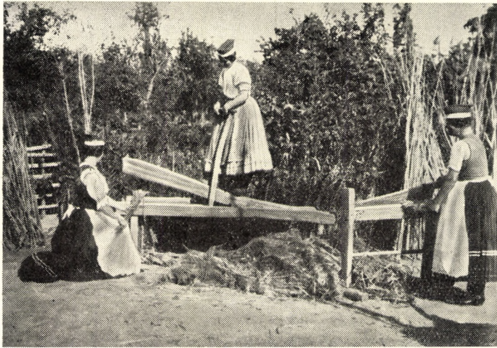
63. ábra. Kölyűs kendertörő — északi típus. Bogács, Borsod-Abaúj-Zemplén m.
