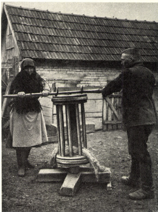
77. ábra. Hengeres kalodás, rögzített bálványos dörzsölő. Csallóköz. (BÁTKY Zs. 1906.)
