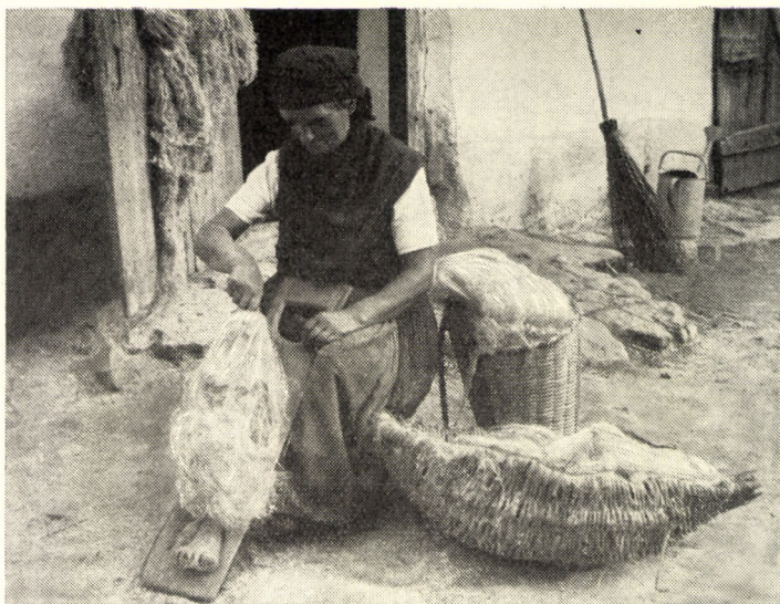
111. ábra. A szegrózsás rostfésű lábbal való rögzítése. Bogács, Borsod-Abaúj-Zemplén m.
