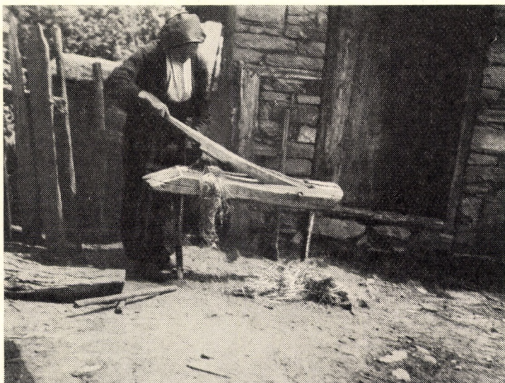
47. ábra. Tiló, két földbevert cövekre helyezve. Momcsilovci, Bulgária. (HR. VAKA-RELSZKI felv.)
