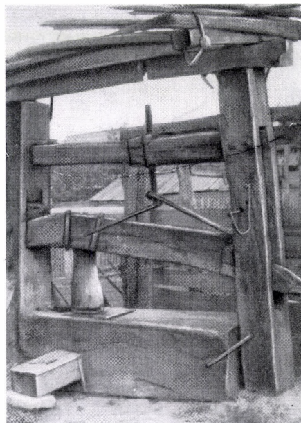
3. kép. Vízszintesen elhelyezett ékekkel működő román olajütő. Szászfenes, Kis- Szamos völgye. Románia. Gunda B. felv.
