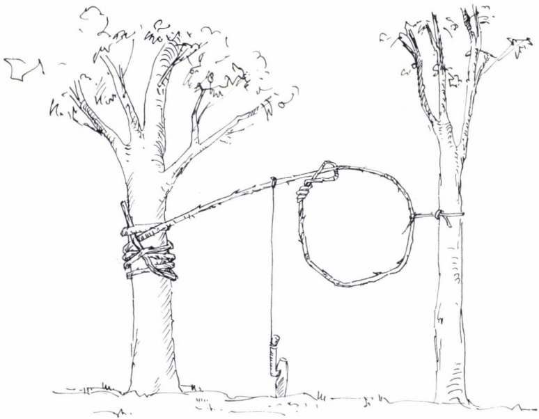
84. kép. A 83. képen bemutatott hurok felállítási módja. Törökkoppány, Somogy m.
