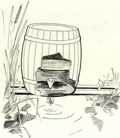
32. ábra. Olajos DDT-emulzió csepegtetésére szolgáló berendezés rizsföldek öntözőcsatornáin (Eredeti)
