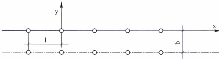
4.2.7. ábra. A hőforrások és nyelők elhelyezkedése
