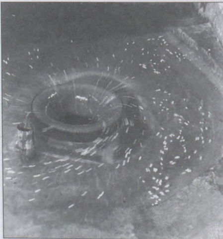
12. ábra. Áramképek: balra az öblözetes, jobbra az öblözet nélküli árvízi túlfolyó felvízi környezetében
