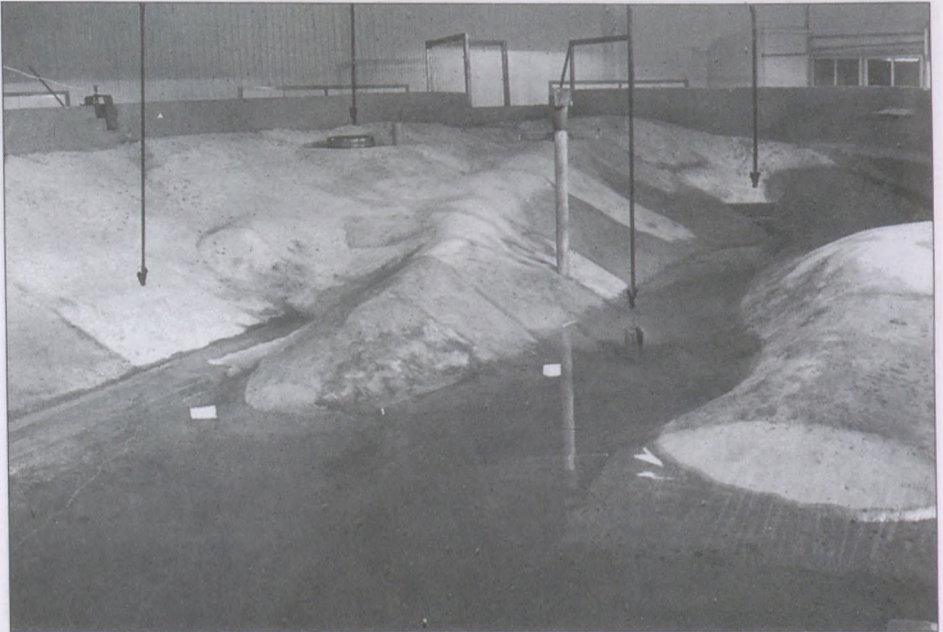
11. ábra A duhoki tározó 1:50 méretarányú modellje az egyes műtárgyakkal. (A középső, kereszt alakú oszlop csak az áthidaló pallók alátámasztására szolgál)
