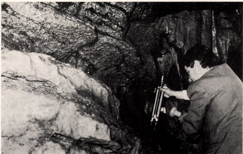
15. kép. A nehéz terepviszonyok mellett a barlang hőmérsékletének és légnedvességi viszonyainak vizsgálatához egyik legalkalmasabb műszer az Assmann-féle aspirációs pszichrométeri (Fotó: Földesi Gy.)
