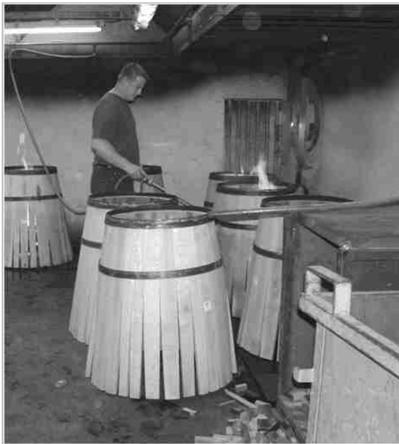
3. ábra. Fahordó abroncsozása. A „szoknyában” ég a tűz. [Trust Hungary, 2008]
