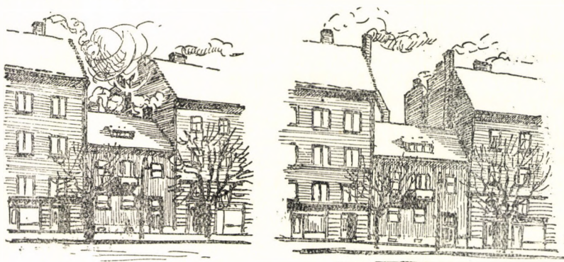
40. ábra. Építésügyi szabályzat írja elő, hogy a régi alacsonyabb épület kéményét utólag meg kell magasítani, ha magasabb ház épül mellette.
