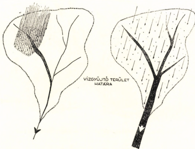
II. ábra. Betörési front esőjének hatása (balról) és felsiklási front esőjének hatása (jobbról) a vízállásra.
