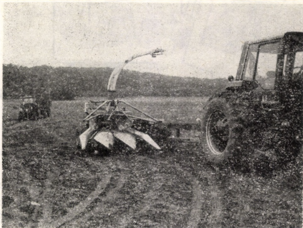
4. ábra. A Hesston-7160 szecskázó
