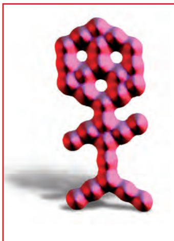
1. ábra. CO emberke. Zeppenfeld és munkatársai szén-monoxid-molekulákat egy platinafelület mentén atomerő-mikroszkóppal egyedileg mozgatva építették ezt a kis molekuláris szobrot, amely 4,5 nm magas és 26 CO molekulából áll.
